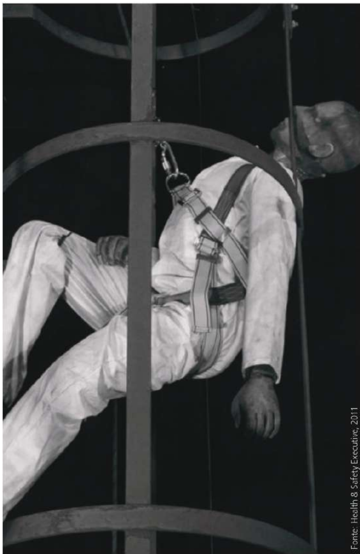
Figura 6: Posição final do manequim de ensaio pós-queda
