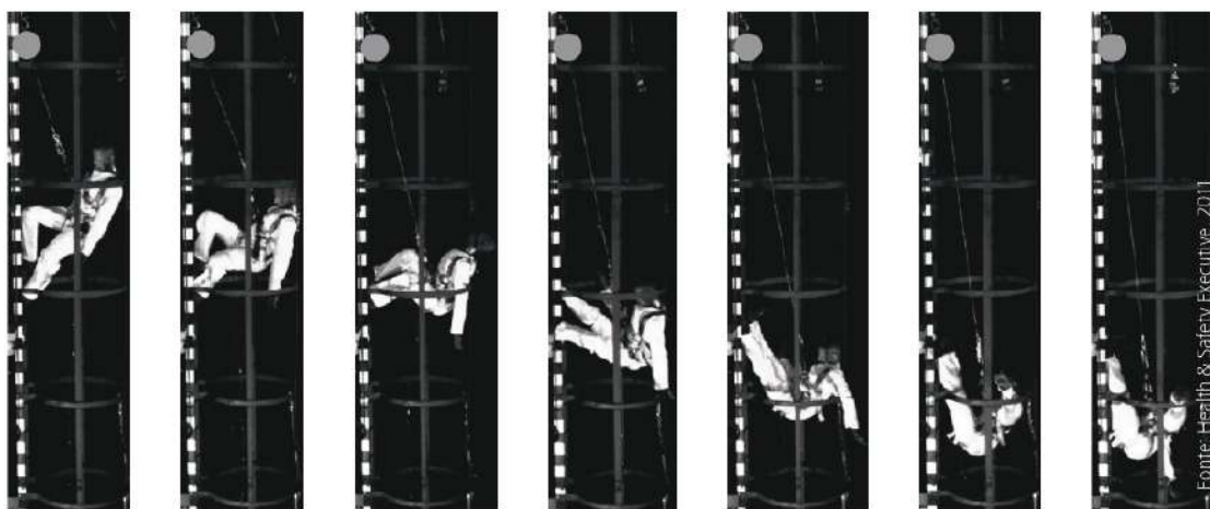
Figura 5 - Queda com trava queda retrátil
