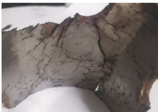
Figura 3: Exemplo de interface em Inox 304 que falhou por SCC com 2 anos de aplicação
