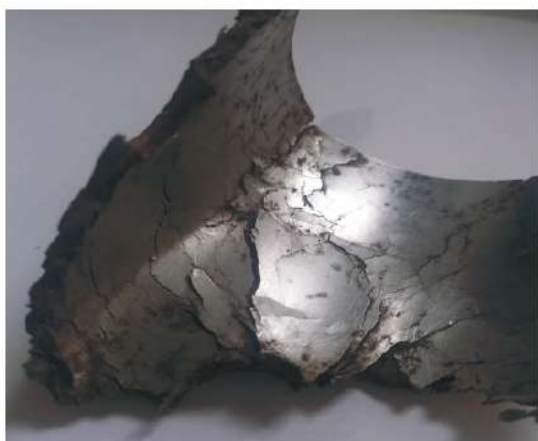
Figura 3: Exemplo de interface em Inox 304 que falhou por SCC com 2 anos de aplicação
