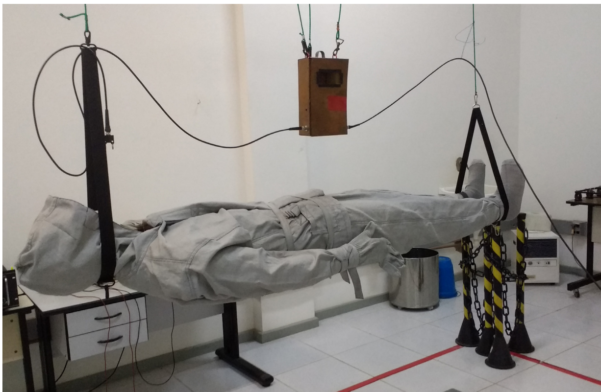
Ensaio de vestimenta condutiva segundo ABNT NBR 16135:2012
